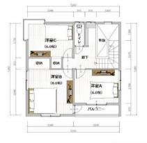
2階 平面図 床面積 1階: 56.31㎡ 2階: 45.95㎡ 延べ床: 102.26㎡
